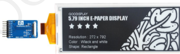
图4.1 电子纸显示屏与转接板插接示意图
